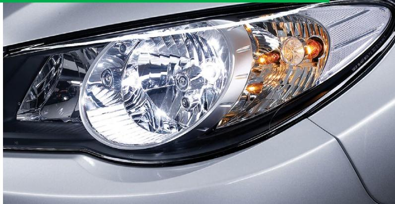
Линейка галогеновых ламп **AUTOPROFI LONG LIFE** – это лампы с цветовой температурой в 3200К, со световым потоком на 30% мощнее, чем у стандартных ламп. Рабочий ресурс более чем в 2 раза превышает обычные лампы.
